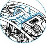
■ Máxima seguridad operativa gracias al sistema de filtro de aire 3 + 1, que consta de un separador ciclónico, un pre-filtro, el filtro principal de gran capacidad, además del filtro del fabricante del motor.
