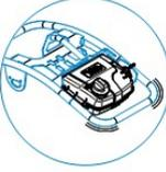
■ Palanca de aceleración con función de apagado del motor con cierre de paso de combustible, marcha lenta y dos velocidades de trabajo.
